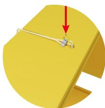
Сквозь верхнюю крышку (6) проденьте провод питания и подключите его к керамическому соединителю проводов.
