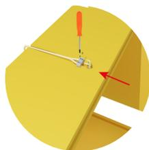
Подсоедините к колодке провод с патроном от лампы и закрепите винтами.
